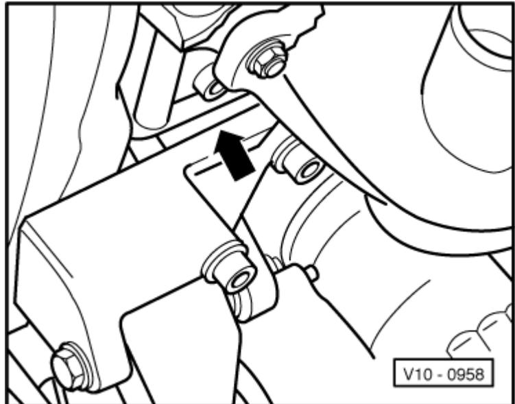
→ Auf der getriebeseitigen Stirnfläche des Zylinderblocks unterhalb des Kühlmittelreglergehäuses
