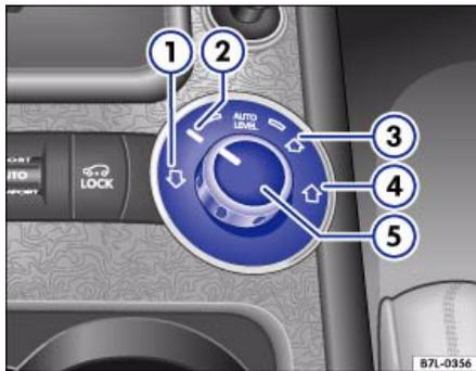
**Abb. 104** Ausschnitt aus der Mittelkonsole: Drehknopf zum Wählen eines Niveaus
