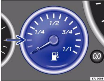
Abb. 5 Ausschnitt vom Kombiinstrument: Kraftstoffvorratsanzeige
