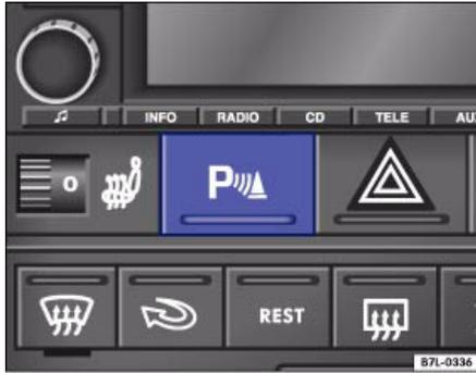
Abb. 111 Ausschnitt aus der Instrumententafel: Taste zum Ein- oder Ausschalten der PDC
