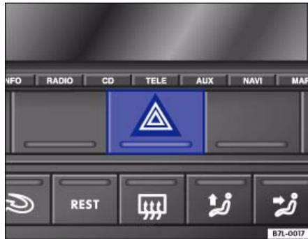
Abb. 44 Ausschnitt aus der Instrumententafel: Schalter für Warnblinkanlage
