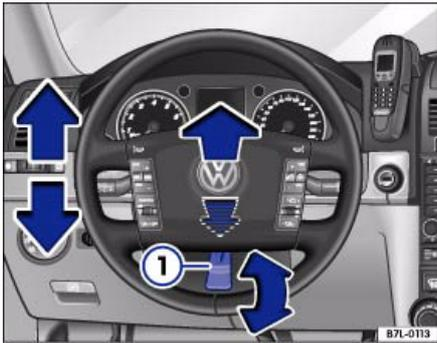
Abb. 62 Hebel ① für manuelle Lenkradeinstellung
