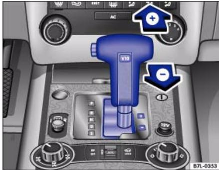
Abb. 101 Mittelkonsole vorne: Automatikgetriebe in der tiptronic-Schaltgasse
