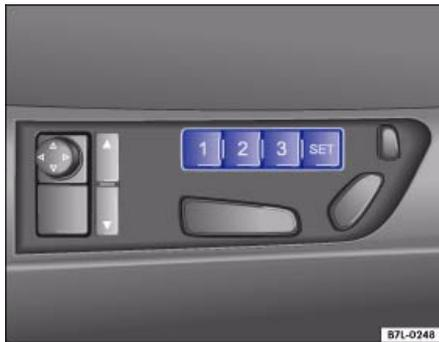
Abb. 59 Memorytasten am Vordersitz: zum Speichern die Taste SET und danach eine der Memorytasten 1, 2 oder 3 drücken.
