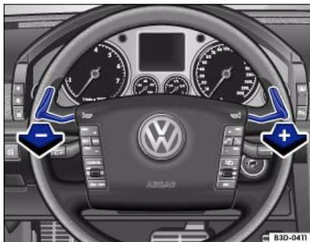
Abb. 102 Lenkrad: Hebel für die tiptronic
