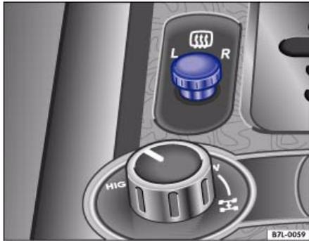
Abb. 51 Ausschnitt aus der Mittelkonsole: Drehknopf für die Außenspiegel
