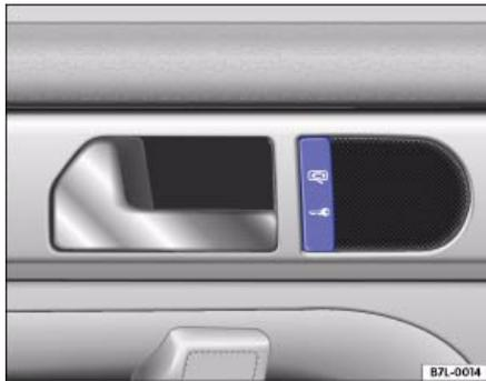
Abb. 26 Ausschnitt der Tür hinten links: Zentralverriegelungstaster
