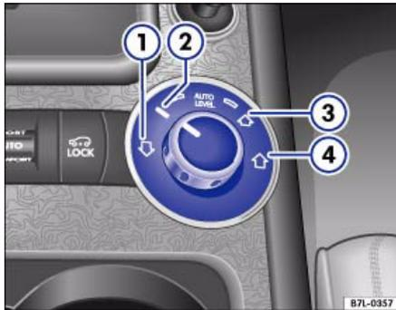
**Abb. 103** Ausschnitt aus der Mittelkonsole: Niveauregelung
