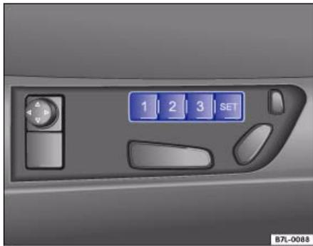
**Abb. 58** Memorytasten am Fahrersitz: zum Speichern die Taste SET und danach eine der Memorytasten 1, 2 oder 3 drücken.
