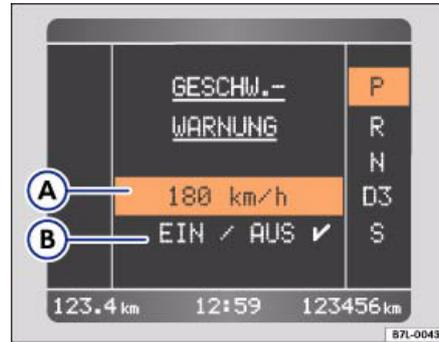
**Abb. 12** Farbdisplay: Geschwindigkeitswarnung ausgeschaltet
