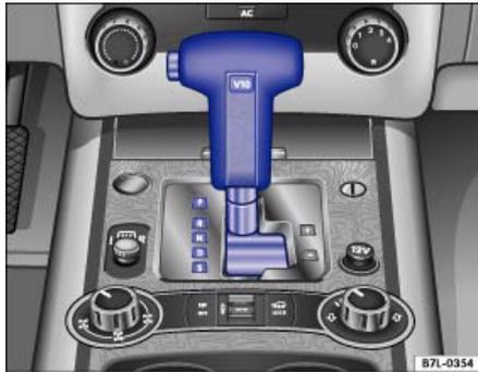
Abb. 100 Mittelkonsole vorne: Wählhebel mit Sperrtaste
