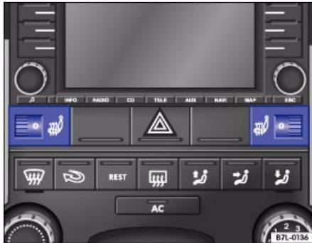
Abb. 65 In der Instrumententafel: Rändelräder der Sitzheizungen für die Vordersitze
