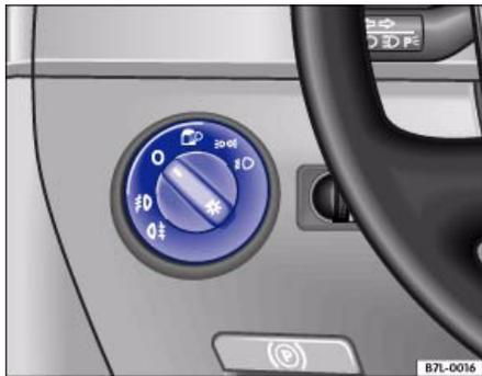
**Abb. 42** Ausschnitt aus Instrumententafel: Schalter für Licht, Nebelscheinwerfer und Nebelschlussleuchte
