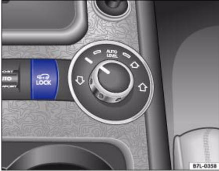
Abb. 106 Ausschnitt aus der Mittelkonsole: Lock-Taste
