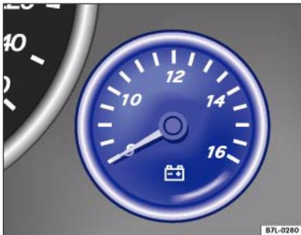
Abb. 6 Ausschnitt vom Kombiinstrument: Voltmeter
