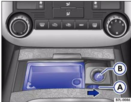
**Abb. 77** Im geöffneten Aschenbecher vorne: Aschenbecher-Einsatz mit Entriegelung **A** und Zigarettanzünder **B**
