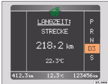
**Abb. 13** Farbdisplay mit Symbol für eingeschaltete Lenkradheizung
