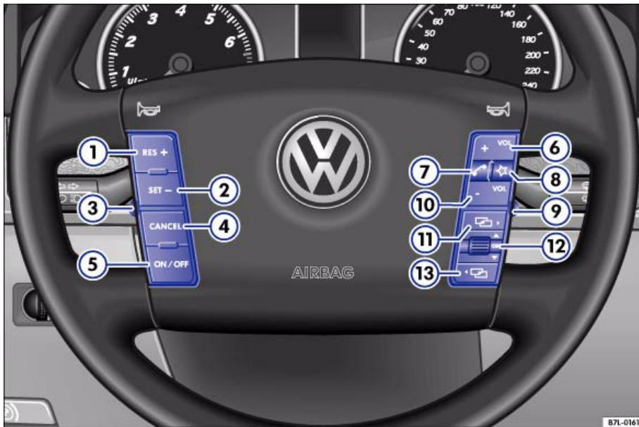
Abb. 2 Multifunktionslenkrad mit Bedienelementen für Geschwindigkeits-Regelanlage, Telefon und das Display im Kombiinstrument.
