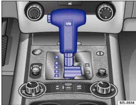
**Abb. 99** Mittelkonsole vorne: Wählhebel vom Automatikgetriebe
