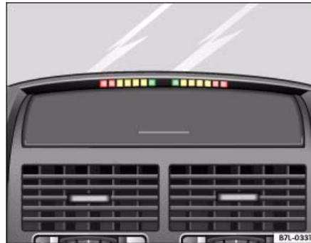
**Abb. 110** Optische Anzeige in der Instrumententafel
