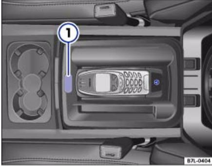
**Abb. 23** In der Armlehne vorne: eingelegtes Mobiltelefon mit angepasstem Adapter und Taste zur Aktivierung der Sprachbedienung
