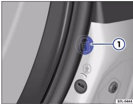
Abb. 29 Notverriegelung ① in der Stirnseite der hinteren rechten Tür
