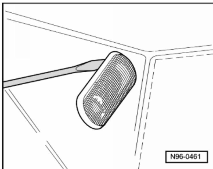
После ремонта фонаря освещения перчаточного ящика необходимо проверить работу выключателя. Лампа не должна гореть при закрытой крышке!
